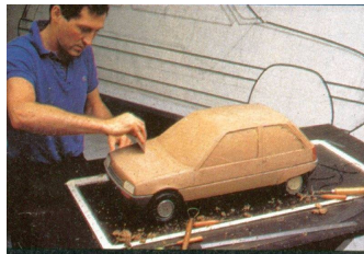
Des designers fabriquent des maquettes au 1/5 ème en plastiline (glaise synthétique)
