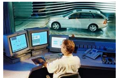
Essai en soufflerie d'une Mercedes Classe C
